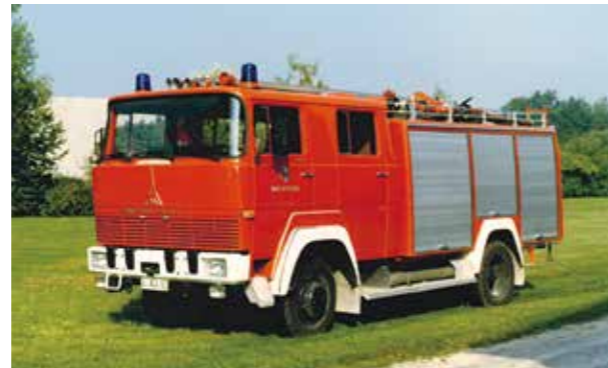
Trockentanklöschfahrzeug TroTL F 16 Magirus, Baujahr 1974
