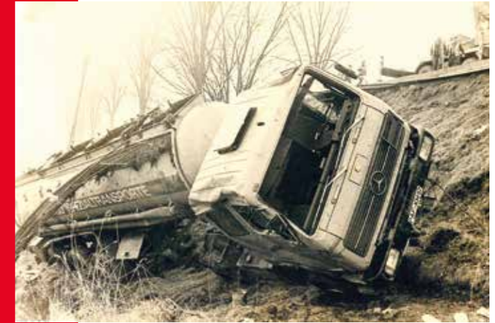
Am 13. Februar 1980 wurde die Werkfeuerwehr Hoechst zum ersten Mal im Rahmen des TUIS-Abkommens bei einem LKW-Unfall auf der Bundesstraße B 300 bei Dasing tätig. Ein mit 20000 Litern Salzsäure beladener Tanksattelzug war von der Fahrbahn abgekommen und umgestürzt. Um das Fahrzeug mit einem Kran bergen zu können, musste die stark ätzende Ladung in ein Ersatzfahrzeug umgepumpt werden.
