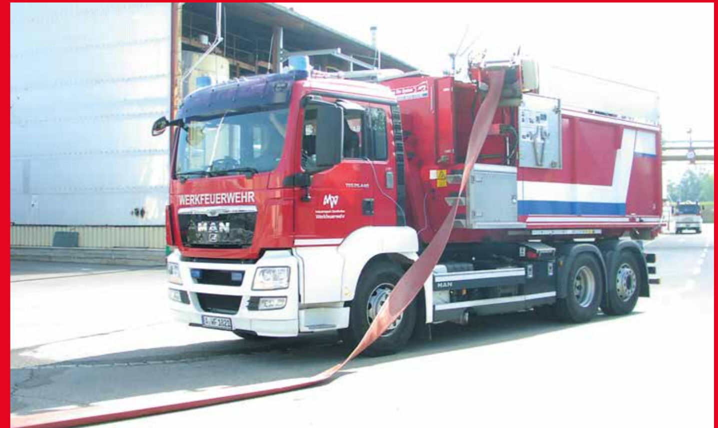
Zur Sicherstellung der Wasserversorgung bei Großbränden oder bei Kühlwasserausfall verfügt die Werkfeuerwehr über ein Schlauchabrollsystem mit F-Schläuchen.
