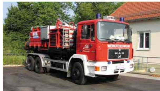
Wechseladerfahrzeug, Baujahr 1990, mit Abrollbehälter Sonderlöschmittel
